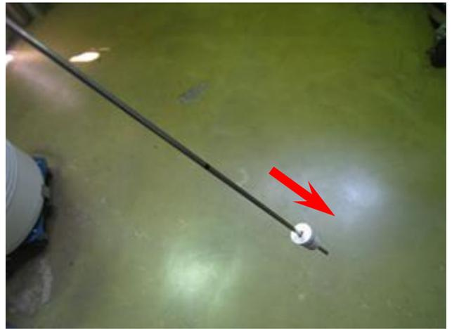
2. 容器のキャップを外します。バルブは閉じたまま検量棒を開口部へ挿入してゴム栓を押し込んで固定します。この時点で検量棒は先端が少ししか挿入されていないのでぐらつきます。検量棒を垂直に支えます。
