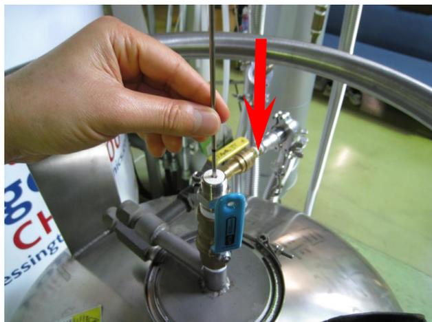
室温の検量棒は液体ヘリウム温度に比べ非常に高温であるため急激に挿入すると容器内のヘリウム冷ガスが膨張します(または液体ヘリウムが蒸発します)。過剰な蒸発損失を防ぐため付帯のバルーンを確認しながらゆっくり挿入します。
