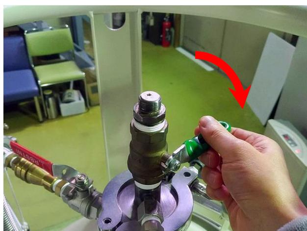
8.検量棒をゴム栓ごと抜きとろうとした場合、ゴム栓が開口部の中まで入り込んでいるため、棒だけ抜けてゴム栓が残ってしまう事があります。ゴム栓の抜き取り方のコツとしては検量棒をグルグル回す(自転ではなく公転させる)と栓が浮き上がってきます。
