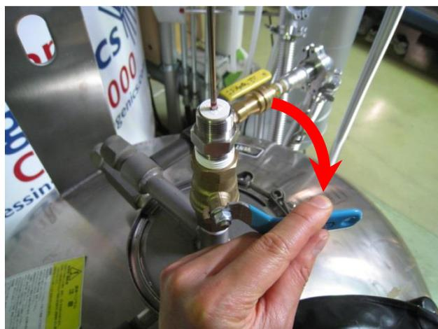
7-2.どうしてもバルブによる液面棒の巻き込みが心配な場合は、ゴム栓を残したまま、液面棒だけ先に抜取り取ってしまいます。この状態でバルブを閉じます。液面棒は完全に離れているので、絶対に巻き込まれません。栓の中心に穴が開いているものの、栓が蓋の役目をしてくれるので、ヘリウムガスの噴出や空気の侵入を少しは抑えられます。この方法の方が7-1よりもシンプルで良いかもしれません。
