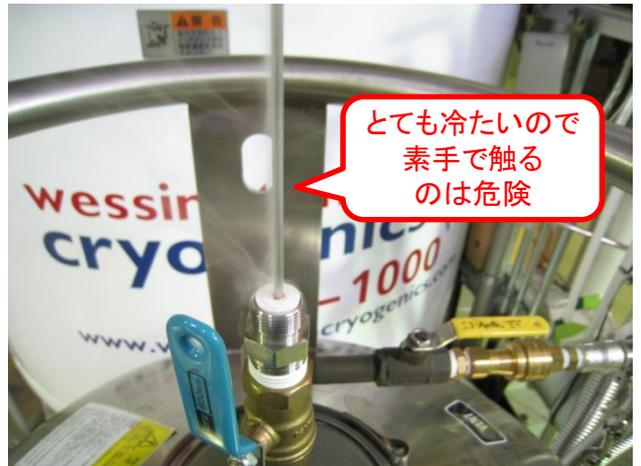
7-1. 検量棒が温まったら検量棒だけ更に引き上げます。検量棒にはあらかじめどこまで抜いたらバルブを越えるのかマークをしておきます。現容器では下端から3.0cm※1にマークすれば全種類の容器でバルブに挟まれません。下端までのストロークが3.0cmと短いため抜き切ってしまう事が多いので少し上に予告線を描いておくと便利です。※1: 新容器16号投入により3.5cmから3.0cmへ変更しました。2017.06
