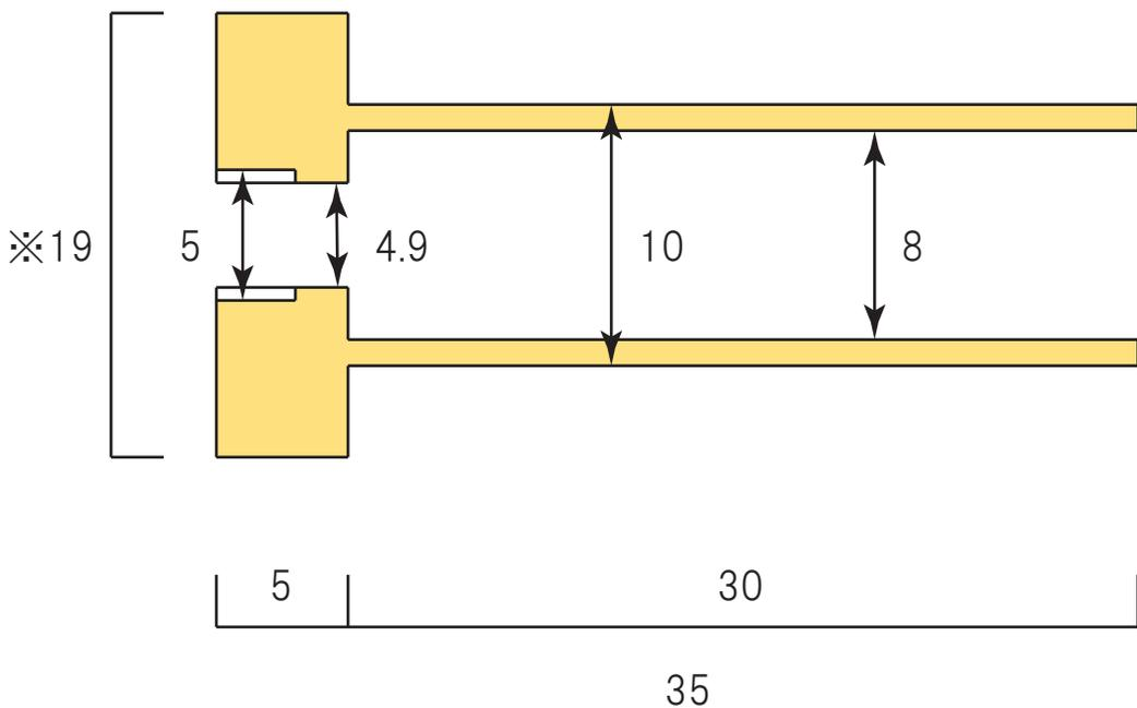
※およそ 19mm だが、ベローに現物合わせして微調整する
