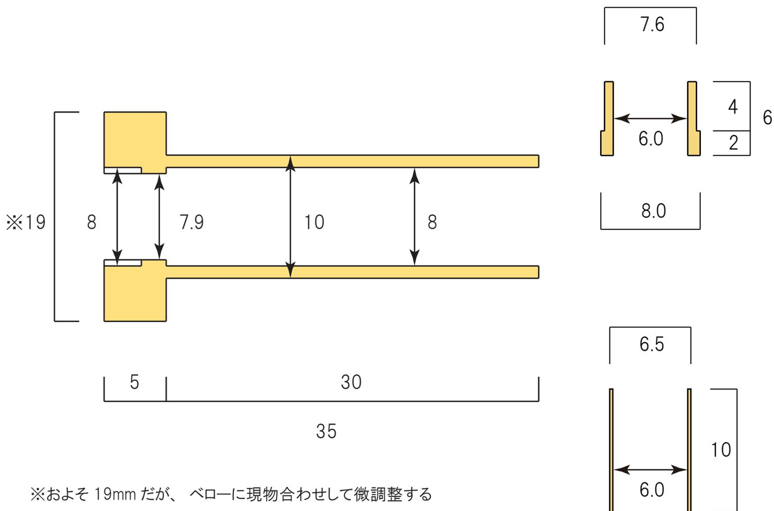
※およそ 19mm だが、ベローに現物合わせして微調整する
